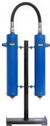
Фильтрационный модуль предназначен для очистки сжатого воздуха и различных газов от аэрозолей, масла и влаги, а также от твердых частиц размером более 10 мкм. Обеспечиваемое остаточное содержание аэрозоля масла - менее 16 мг/м<sup>3</sup>. Используется в системах пневмоуправления и автоматизации, пневмоприводе устройств и инструмента для окраски поверхностей распылением.
